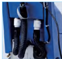
放水管 Sewage pipe
